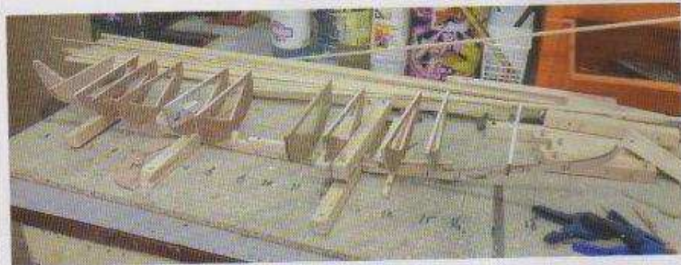
Positionnement des couples sur la quille, selon le principe du chantier dit en l'air.
