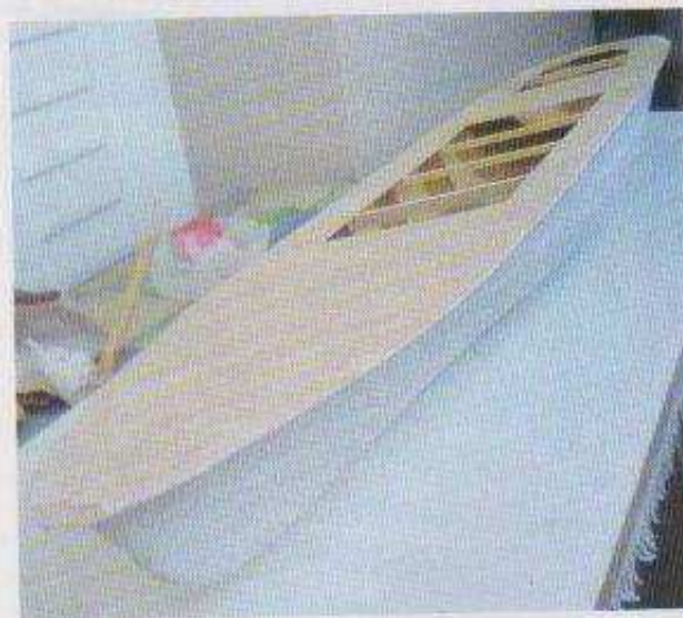
Denier ponçage de la coque.
