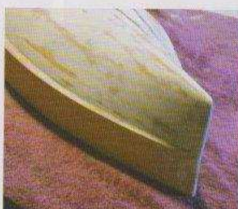
Ponçage sur la coque résinée et stratée.
