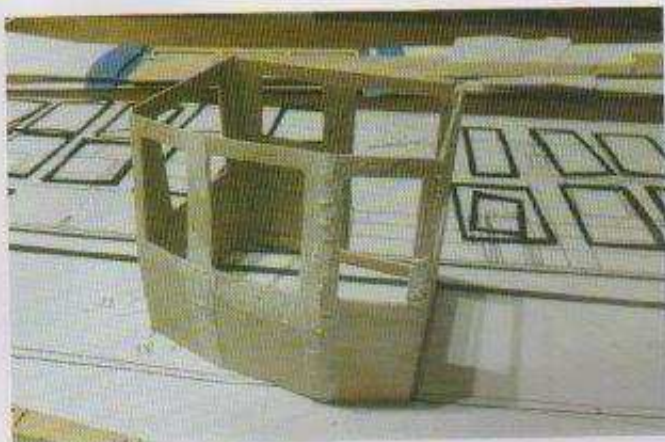
Assemblage des premiers éléments de la cabine.
