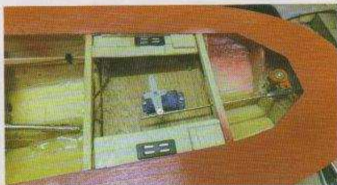
Un mini servo est assez puissant pour traiter le safran. Notez les aimants destinés à maintenir le pont en place.
