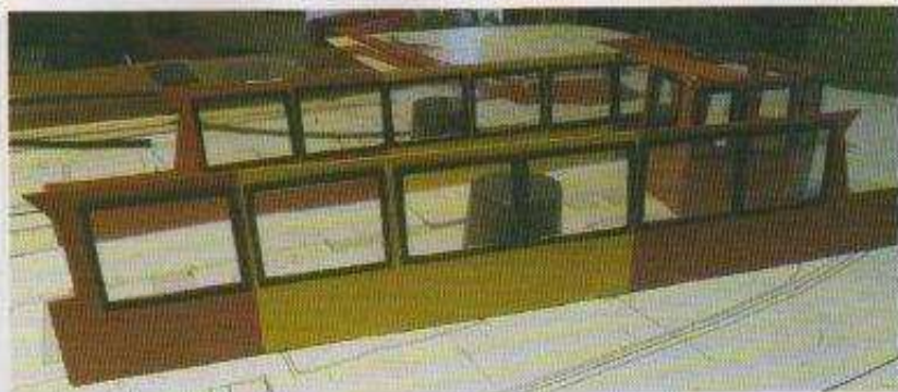
Mise en peinture de la structure de la cabine passager.
